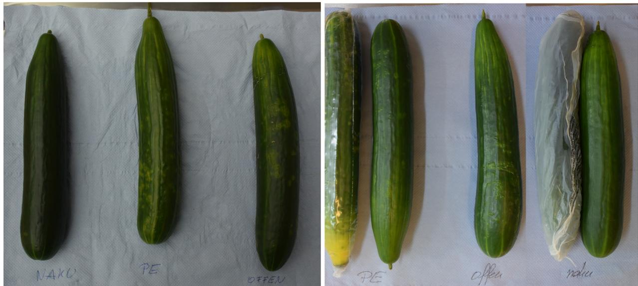
**Abbildung 3:** Aussehen der Gurken nach 13 (links) und 17 Tagen (rechts) Lagerungsdauer bei 22°C. Reihenfolge linkes Bild: naku-Folie, PE-Folie, unverpackt; Reihenfolge rechtes Bild: PE-Folie, unverpackt, naku-Folie.
