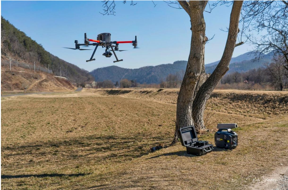
Abbildung 4-5: RTK-Bodenstation und Drohne (© R. Schneeberger)
