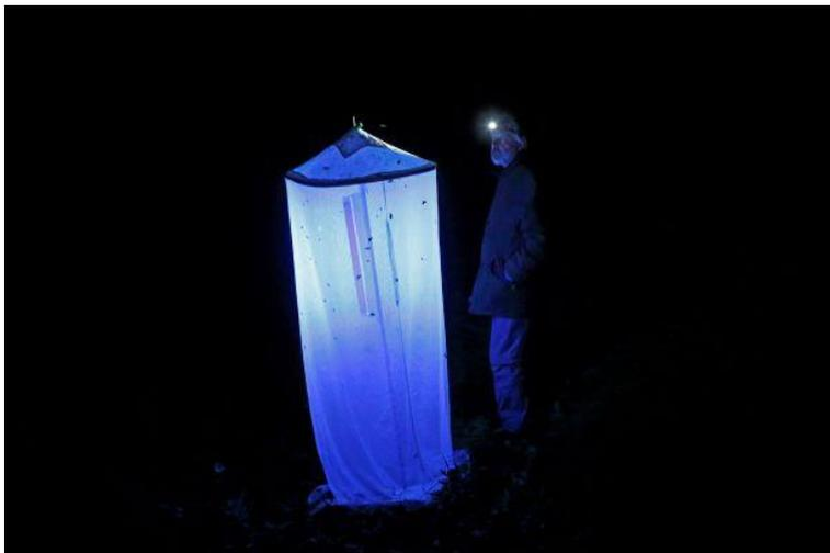
*Bild 6: Großer Leuchtturm am Ringkogel, 2 Leuchtröhren a'20 Watt.*
