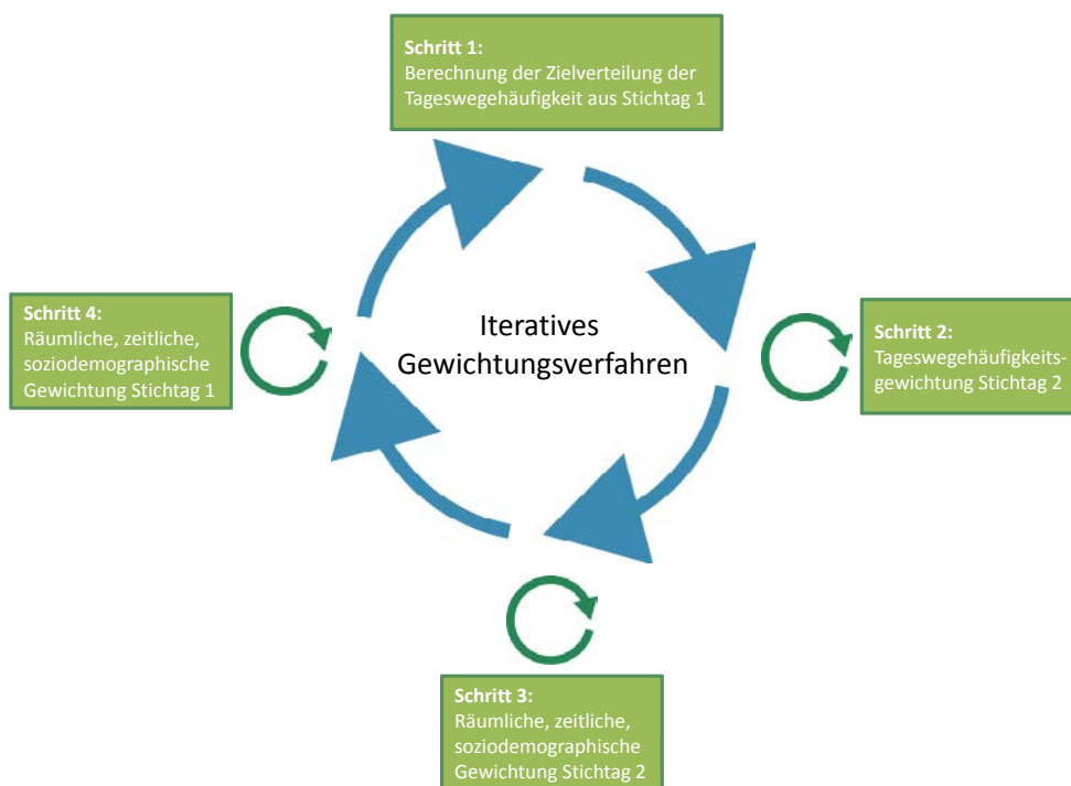
Abbildung 2-2 Schematische Darstellung des iterativen Gewichtungsverfahrens auf Berichtstagebene
