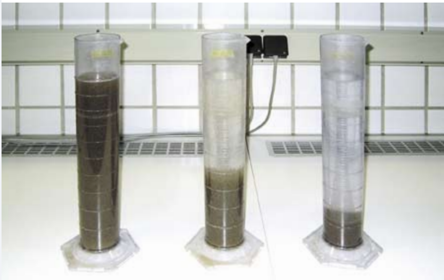
Standzylinder zur Bestimmung des Schlammvolumens
